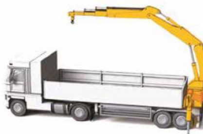
Grue de chargement montée en porte à faux arrière
