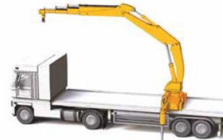
Grue de chargement montée en position centrale
