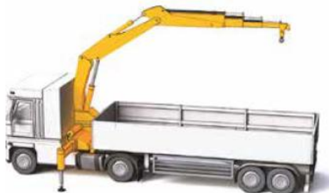
Grue de chargement montée derrière la cabine
