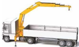
Grue de chargement montée derrière la cabine
