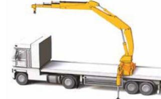
Grue de chargement montée en position centrale
